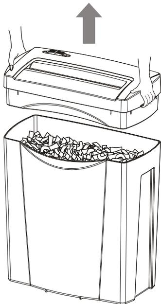
1. Снимите режущий блок
